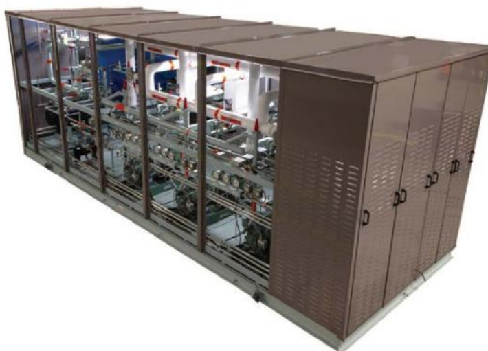
Ammonia CO2 Cascade
