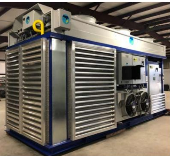
MRBraz ammonia/glycol chiller
