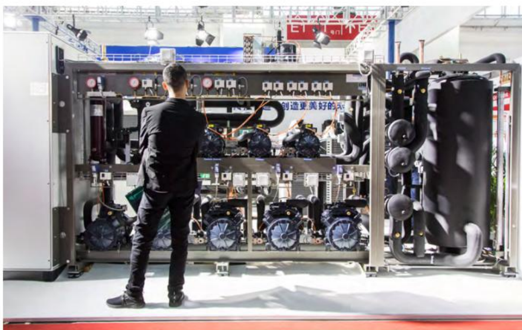
北京で開催された中国制冷展で 展示されたパナソニックの CO 2 トランスクリティカルラックシステム
